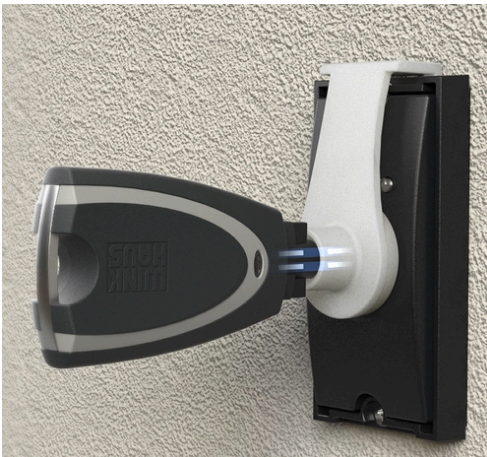
Навесить адаптер для программирования и вставить мастер-ключ
