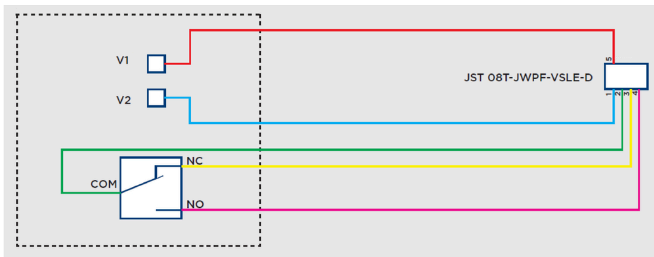
Кабельная разводка реле
